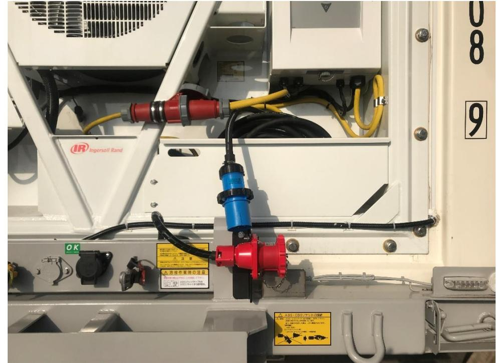
乗船輸送・支柱電源接続時はシャーシ側からプラグを抜き、MAGNUM(マグナム)手前の**赤プラグ(メス)**に黄色コード赤プラグを差し込みロックして下さい！
