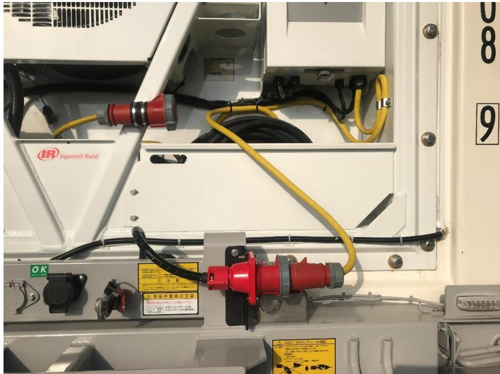
陸輸送時はシャーシの**赤プラグ(メス)**に黄色コード赤プラグを差しロックして発電機を回し発電を確認後、MAGNUM(マグナム)の電源をONにしてください！
